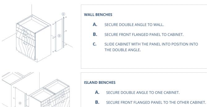
**C.** SLIDE CABINET WITH THE DOUBLE ANGLE INTO POSITION ON THE PANEL ATTACHED TO THE OTHER CABINET.
