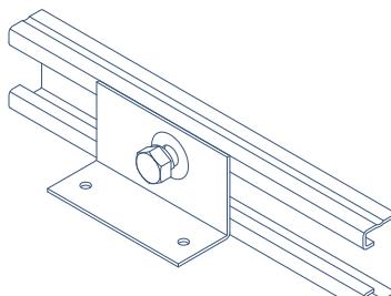
**FUME HOOD SEISMIC BRACE**
